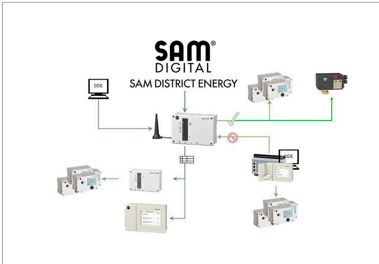
**Bild 2:** Modbus-Kommunikation · Aufbau
