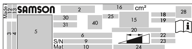
Рис. 1: Информация на типовом шильдике на приводе Typ 3271/3277 или Typ 2780 с площадью привода 120 см 2 соответственно
