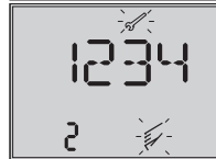
Leserichtung für Anbau pneumatische Anschlüsse links
