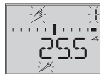
Hand-Führungsgröße w (angezeigt wird der aktuelle Drehwinkel)
