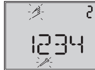
Leserichtung für Anbau pneumatische Anschlüsse rechts
