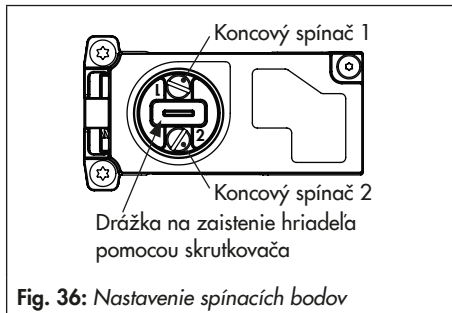
Fig. 36: Nastavenie spínacích bodov
