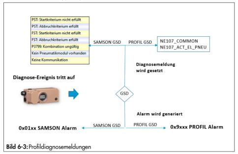
Kommt es im Stellungsregler zu einem Diagnoseereignis wird entsprechend der verwendeten GSD ein Diagnosealarm gesetzt:
