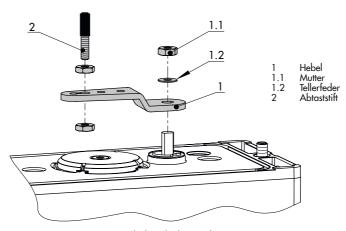
Bild 5-4: Montage von Hebel und Abtaststift
