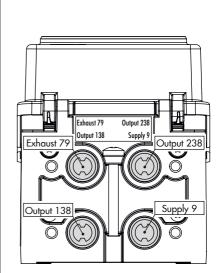
Bild 5-32: Pneumatische Ausgänge
