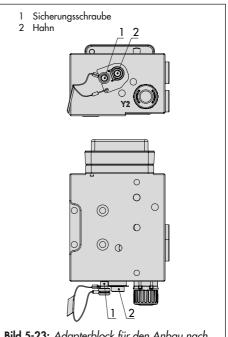
**Bild 5-23:** Adapterblock für den Anbau nach VDI/VDF 3847-2
