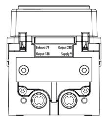
**Bild 5-33:** Ausgang 238 und Entlüftung 79 mit Blindplatte verschlossen
