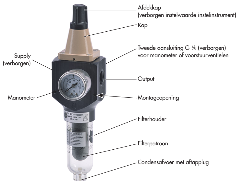
Fig. 1: Afzonderlijke onderdelen van de drukregelaar van het type 4708-45 (uitvoering in aluminium)
