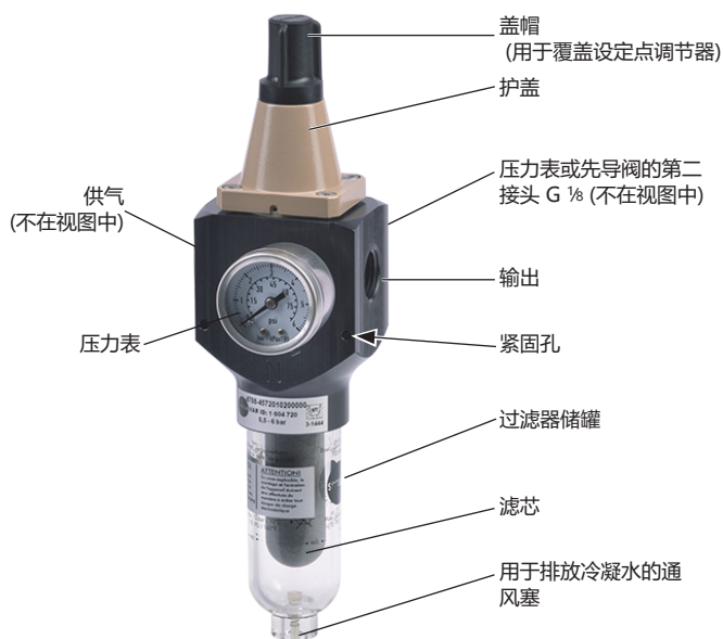
图1: 4708-45 型空气过滤减压阀的组件 (铝制类型)
