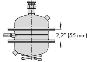
Typ 42-25 mit Doppelmembranantrieb (Sonderausführung).
