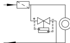
Einbau in Kurzschlussleitung
