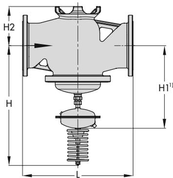
Ventil Typ 2422 membranentlastet mit Antrieb Typ 2425/2420
